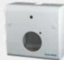
Cassetta per montaggio esterno a muro, completa di pannello di copertura in acciaio inox satinato, idonea per l'alloggiamento di basi e completamenti di presa **EN ISO 9170-2 AGSS tipo 1** con accesso frontale per la taratura facilitata della presa.
